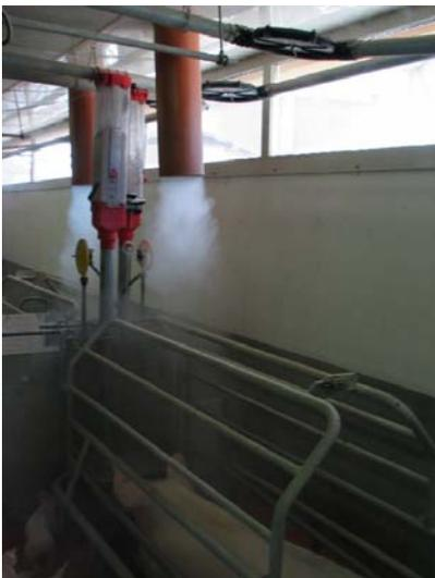
Abbildung 1: Rauchprobe bei der Nasenlüftung von oben
